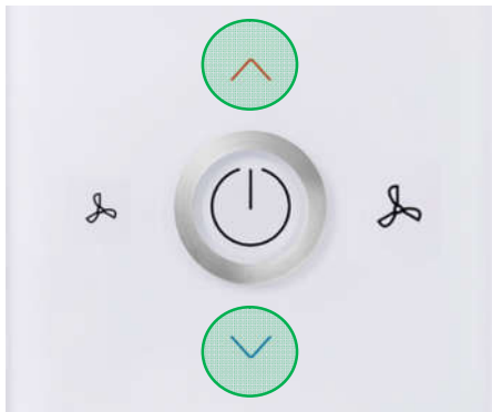
Abbildung 6 Tastenkombination zum Aufruf des Parametermenüs Modbus
