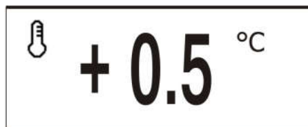
Abbildung 13 Anzeige Sollwertverstellung
