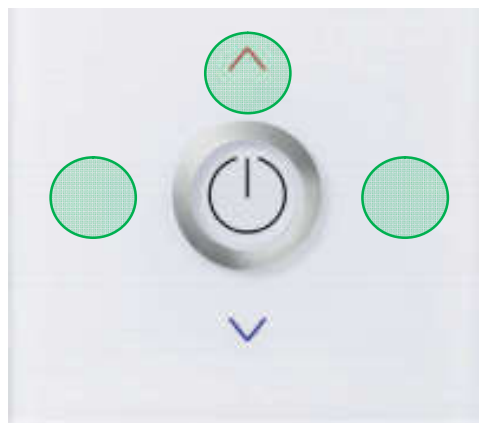
Abbildung 3 Tastenkombination HC-Variante zum Aufruf des Parametermenüs
