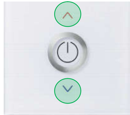
Abbildung 7 Tastenkombination zum Aufruf des Parametermenüs Modbus
